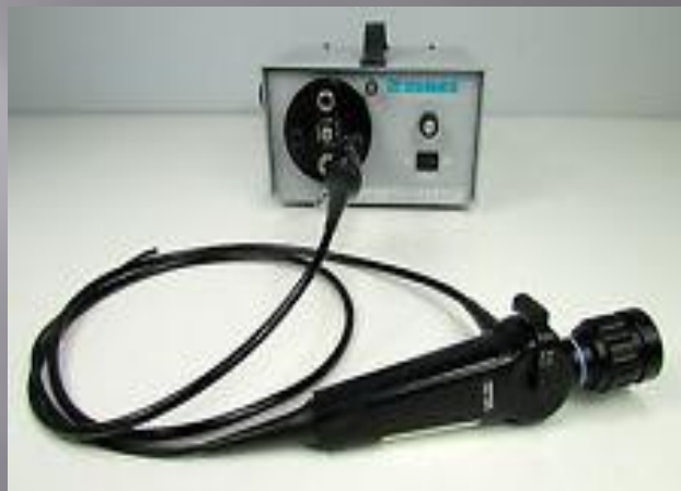
PENTAX FI- 7P, FI-7BS|RBS – наружный диаметр 2,4 мм
